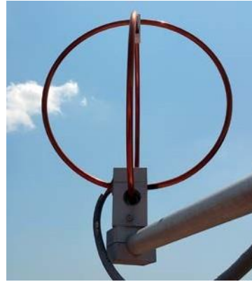
Fig. 24 – Sensor-Antena de campo LINET.
